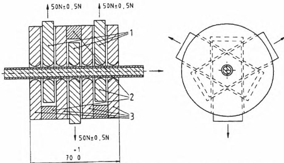
1 – движущиеся пластины; 2 – пространство; 3 – закрепленные пластины
