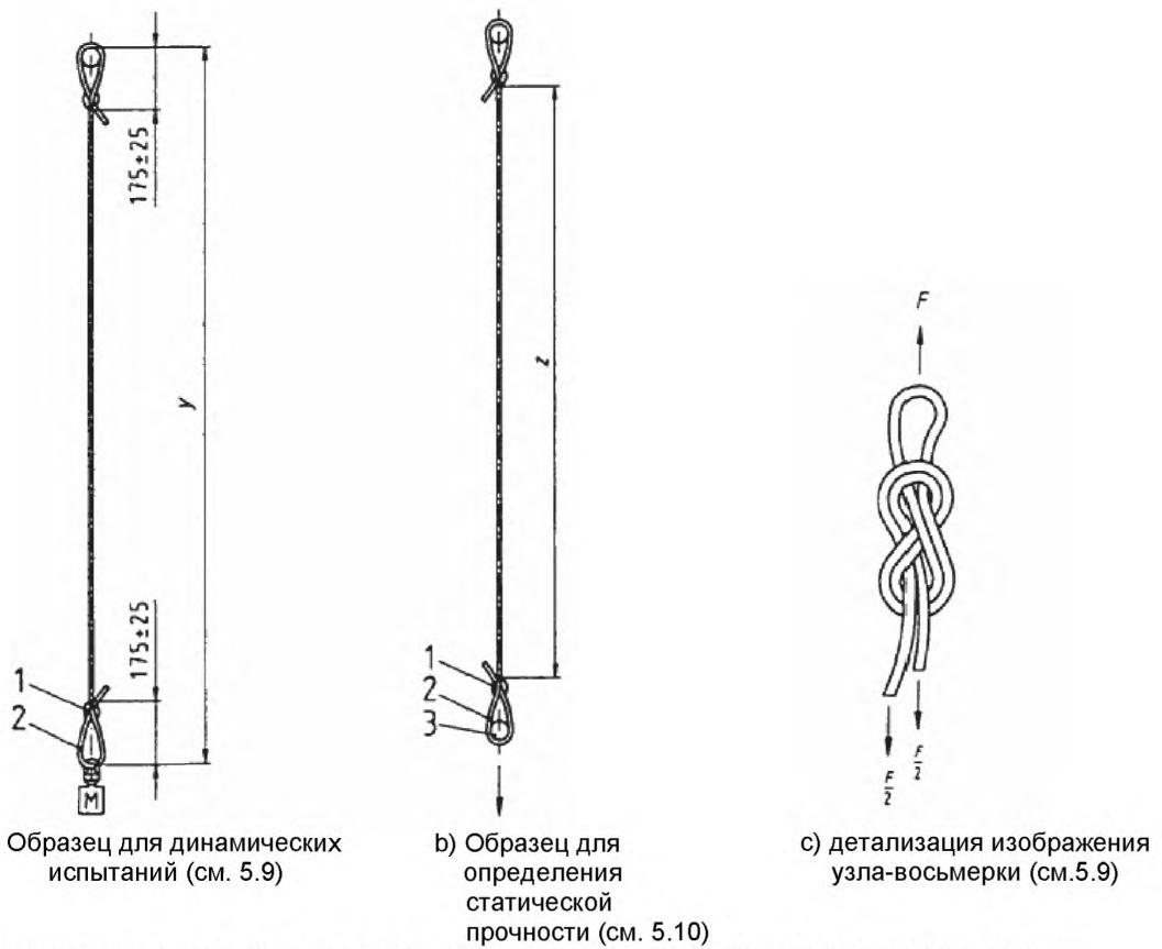
П р и м е ч а н и е – Узел затянут равномерно вручную. Обеспечивает параллельность канатов.
