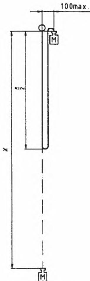
$x$  – расстояние после определения максимальной силы торможения при полной остановке по 5.9.4;
