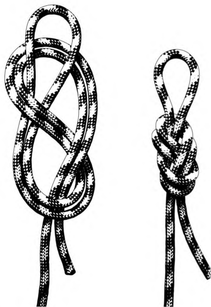
Рисунок А.8 — Схема узла «восьмерка»
