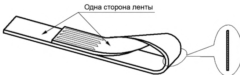
Рисунок 8 — Скрученная петля стропа
